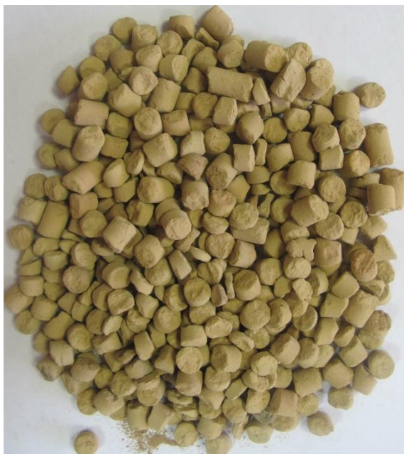
Рис. 1. Огарок – гранулят, обожженный при температуре 900 °С. Fig. 1. Calcine – granulate, annealed by 900 °С temperature.
