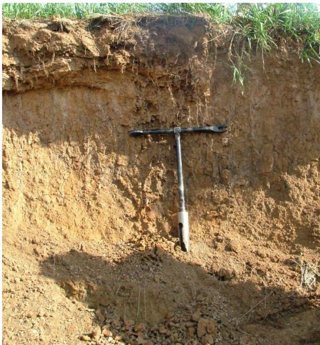
**Рис. 1.** Типичный профиль квазизема – техногенного поверхностного образования (летное поле аэродрома “Домодедово”, Московская область).
