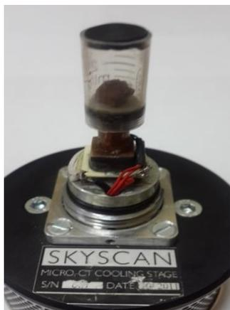
**Рис. 1.** Терморегулирующий модульный столик с почвенным агрегатом.
