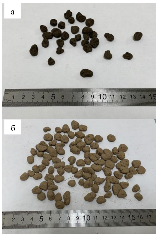
Рис. 2. Округление агрегатов в ходе длительного просеивания (> 4 минут). а – агрочернозем, б – агродерново-подзолистая.
