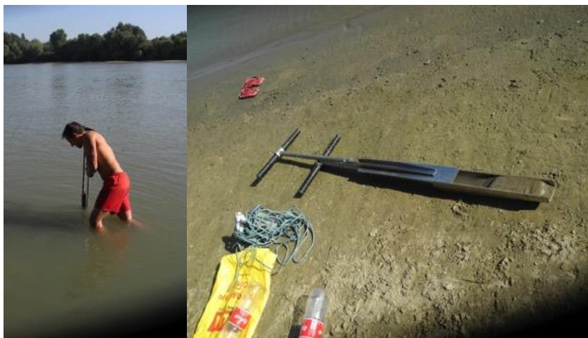
Рис. 1. Извлечение профиля подводных почв с помощью бура Eijkelkamp для отбора проб донных грунтов ненарушенного строения.
