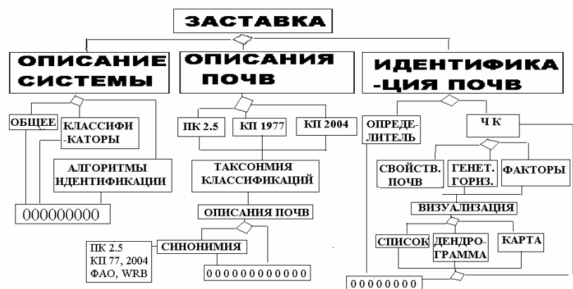
Рис. 3. Структурно-функциональная схема информационной системы классификации почв (нулями обозначены концовки блоков).
