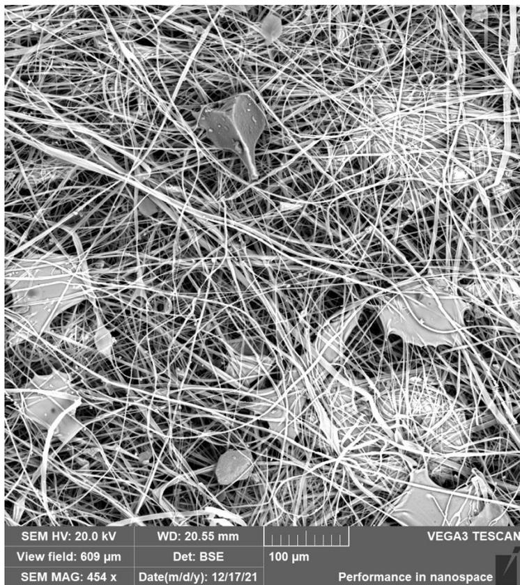
**Рис. 1.** Пример изображения частиц пыли на фильтре при увеличении в 454 раза (видны частицы пыли неправильной формы и волокна фильтра).
