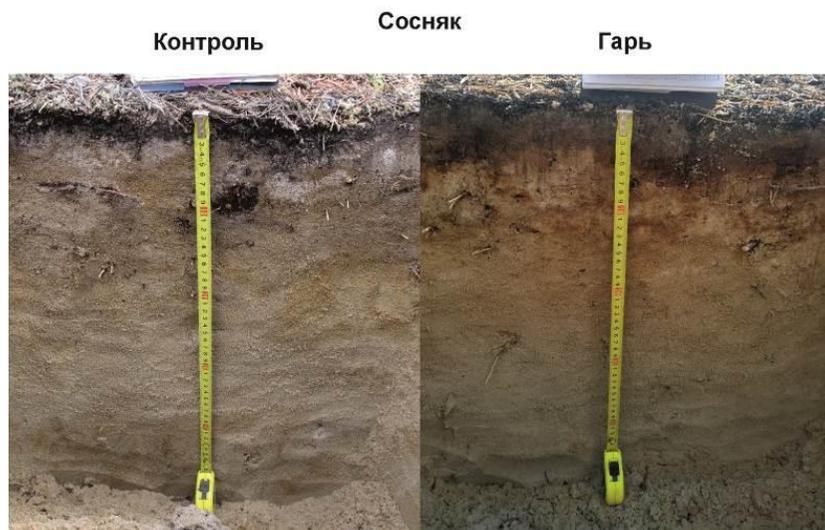
**Рис. 7.** Окисление железа в верхней части профиля.
