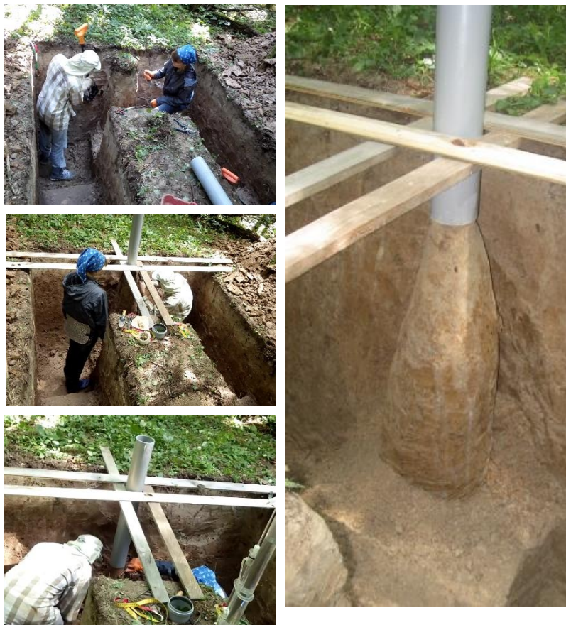
Рис. 3. Организация отбора монолита D = 10 см, L = 50 см для томографического исследования. Окапывание вертикальной колонны почвы с последующей обрезкой по периметру и надвигом полипропиленовой трубы. Опасность представляет возможность перелома столба почвы в процессе отбора. Особенно если отбор ведется с небольшим наклоном (фотографии Хохлова С.Ф. и Скворцовой Е.Б.).
