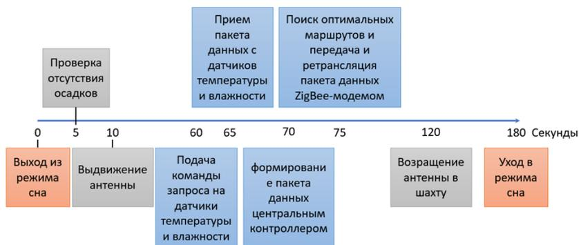
**Рис. 4.** Порядок выполнения работы сенсорных узлов.
