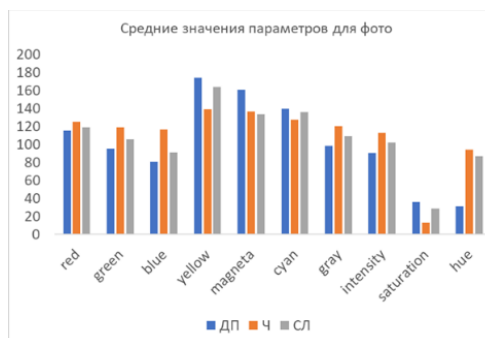
Рис. 1. Средние значения параметров в разных цветовых системах для разных типов почв: ДП – дерново-подзолистая почва, СЛ – серая лесная почва, Ч – чернозем. По оси ОУ – значения отражения.
