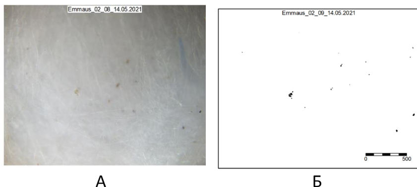
Рис. 3. Пример классификации изображения фильтра с пылью при увеличении в 40 раз ( А – исходное изображение, Б – результат классификации: черные точки – пылеватые частицы на фильтре).
