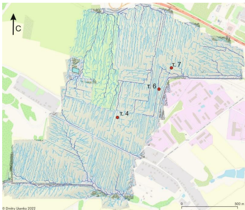
Рис. 3. Карта потоков, рассчитанных по модели SWAT на территории опытного поля, с выделением наиболее крупных потоков (синие линии) и экспериментальных точек опробования.
