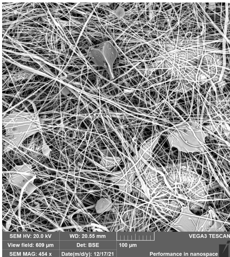
Рис. 1. Пример изображения частиц пыли на фильтре при увеличении в 454 раза (видны частицы пыли неправильной формы и волокна фильтра). Fig. 1. Example image of dust particles on the filter at \times 454 magnification (irregularly shaped dust particles and filter fibres can be distinguished).
